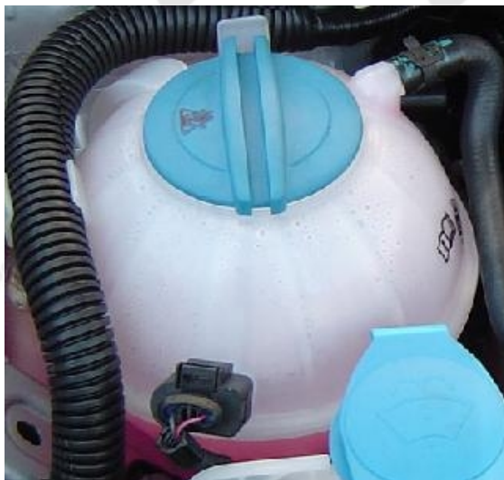
Ilustración 1: Un tipo de botella de expansión
